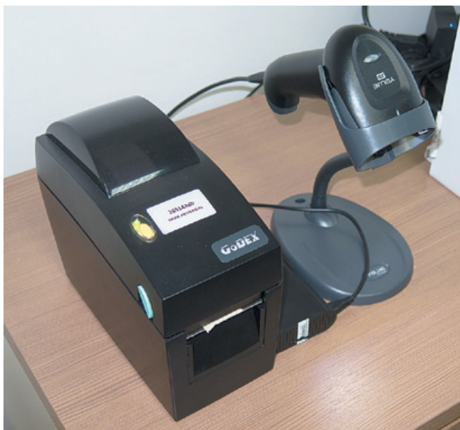
Сканер штрих-кодов и принтер этикеток контролируются микрокомпьютером и функционируют автоматически
