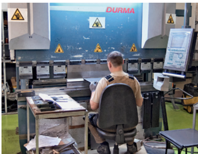
Листогибочный пресс. Изготовление деталей корпусов
