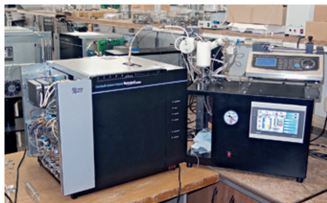
Система для анализа трансформаторного масла на содержание спиртов
