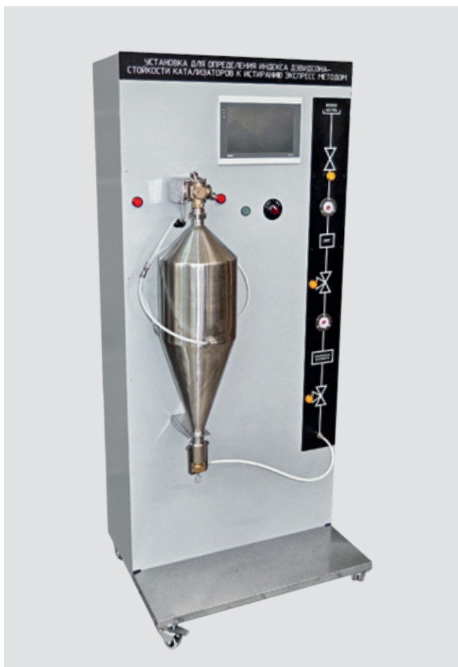
Установка для определения стойкости микросферических катализаторов при истирании согласно методике ASTM D 5757-11
