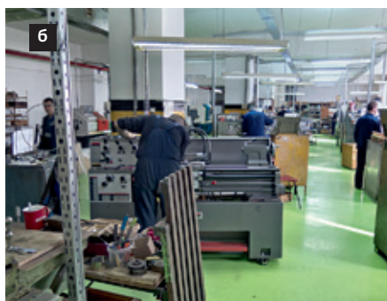
а) Заготовительный участок; б) участок мехобработки. Ручные станки используются для задач НИОКР; в) автоматические обрабатывающие центры с ЧПУ. Один оператор управляет двумя такими центрами
