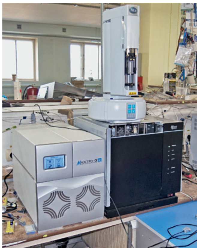
Система ГХ/МС в составе ГХ "Кристаллюкс-4000М" и масс-спектрометра "Маэстро-аМС" компании "Интерлаб". Используется автосемплер компании НТА
