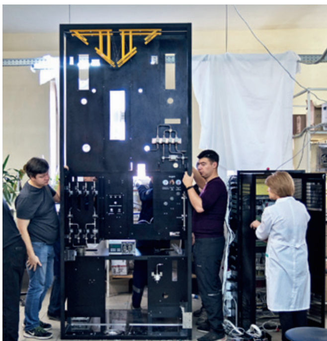
Пилотная установка тестирования каталитической активности готовится к отгрузке заказчику. Она предназначена для исследований и испытаний каталитической активности железнокалиевых катализаторов в реакции дегидрирования этилбензола
