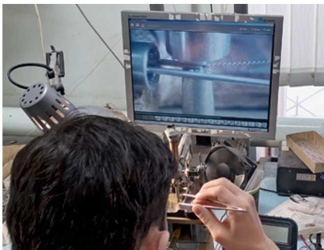
Разварка вольфрам-рениевых спиралей для датчиков по теплопроводности
