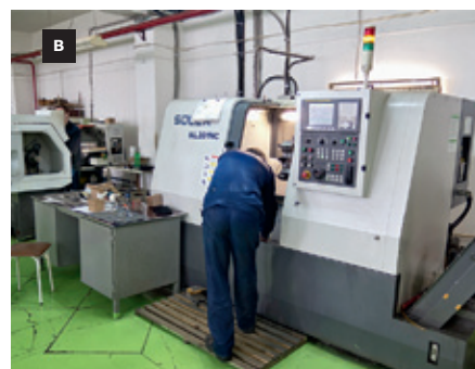
а) Заготовительный участок; б) участок мехобработки. Ручные станки используются для задач НИОКР; в) автоматические обрабатывающие центры с ЧПУ. Один оператор управляет двумя такими центрами
