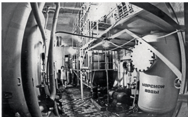
Рис.4. Пилотная установка по извлечению из морской воды Li, K, Cs и Sr. Сахалинская ГРЭС, 1986 год
