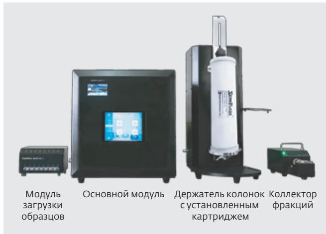
Рис.5. Высокопроизводительная система SepaBean machine L
