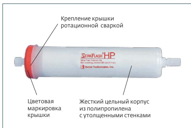
Рис.8. Флэш-картриджи SepaFlash серии HP
