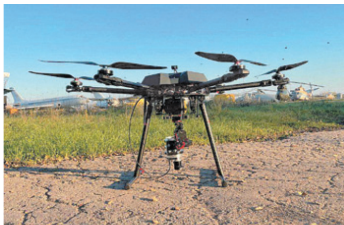
Рис.4. Гиперспектрометр на основе схемы Оффнера на БПЛА
