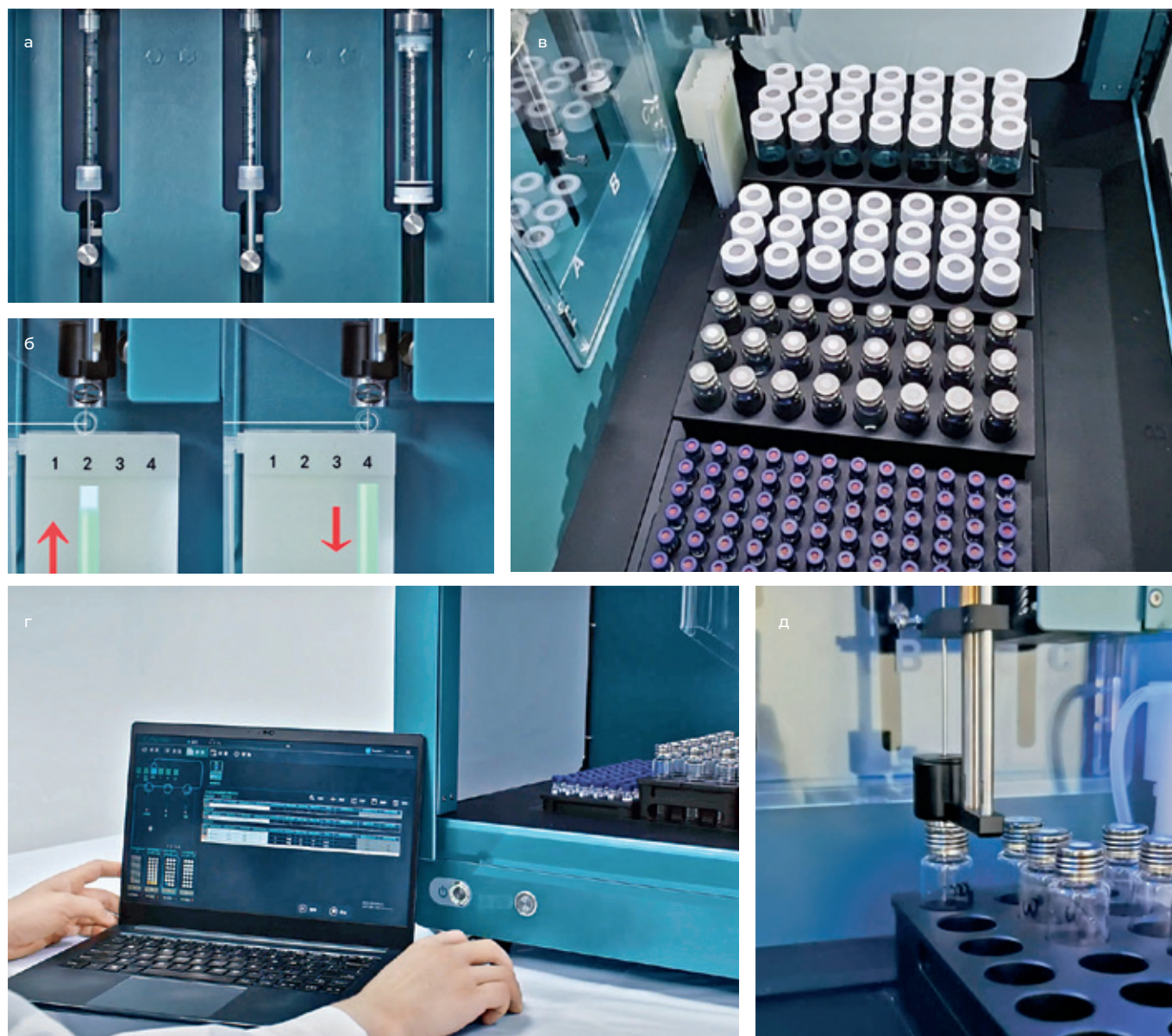
Рис.5. Технологии, реализованные в RayKol AP 300, делают процедуры дозирования и разбавления простыми и удобными: а – высокоточные шприцевые насосы на 100 мкл, 1 мл и 10 мл; б – станция многократной промывки игл; в – платформа для образцов с модулями охлаждения и перемешивания и возможностью работы с пробирками разного размера; г – управление с ПК по Wi-Fi; д – высокоточный модуль для отбора проб
