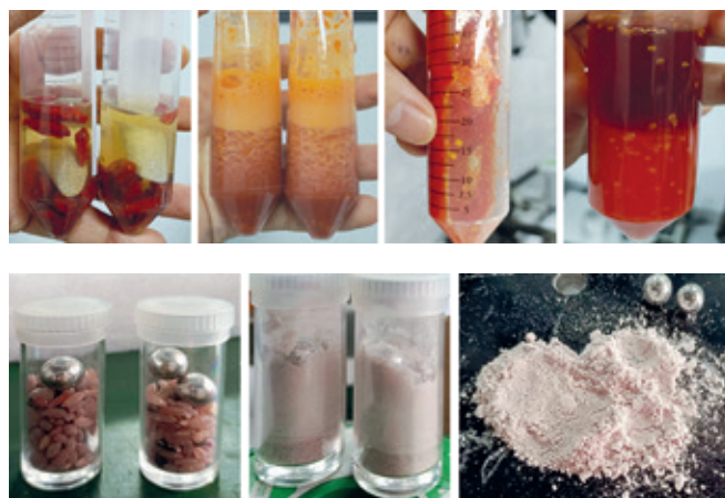
Рис.8. Подготовка растительных образцов методом QuEChERS на RayKol V20: а – гомогенизация ягод дерезы обыкновенной ( Lycium barbarum ); б – измельчение не очищенного от отрубевой оболочки зерна риса ( Oryza sativa )
