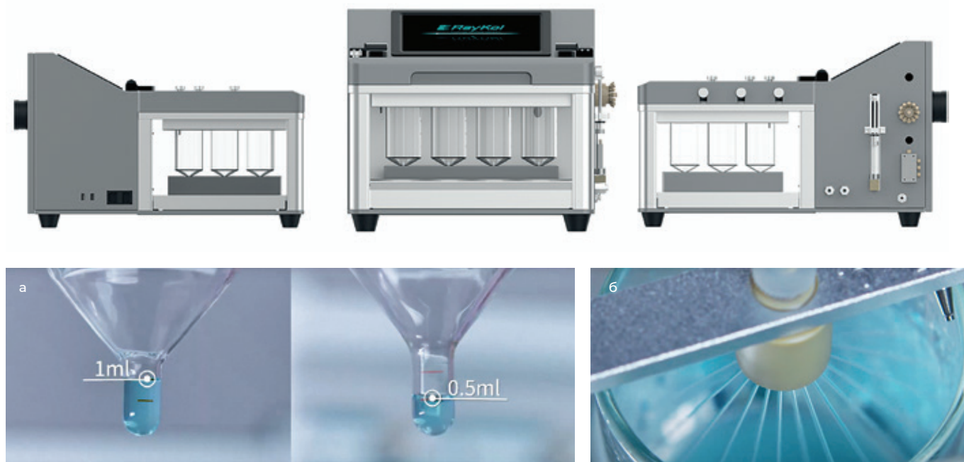
Рис.15. RayKol Auto EVA 12A: вверху – общий вид; внизу – точный объем жидкости в конечной точке концентрирования контролирует оптоволоконный датчик (а); автоматический режим ополаскивания стенок пробирок (б)
