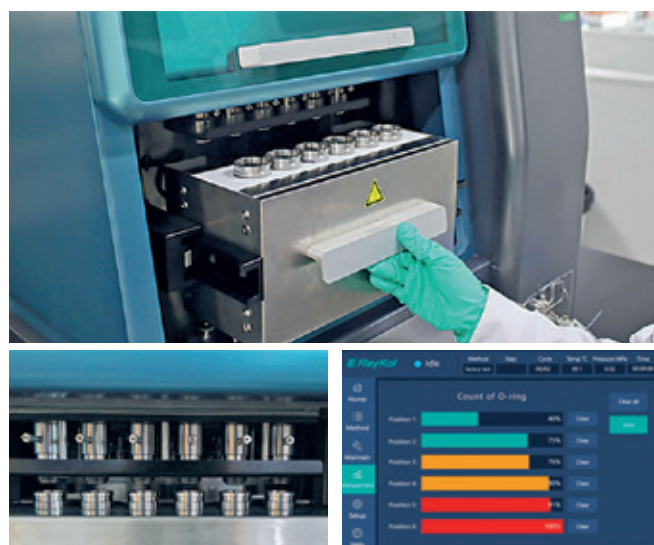
Рис.12. Модуль нагрева RayKol HPFE 06SD, внизу справа – индикация ресурса уплотнительных колец экстракционных ячеек
