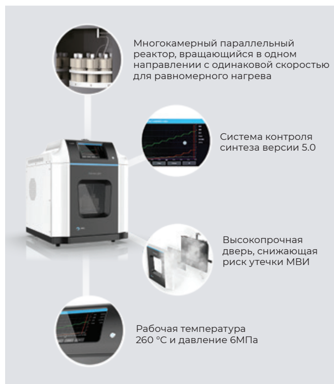
Рис.11. Отличительные особенности микроволнового гидротермального реактора ХН-800SP Nanocube
