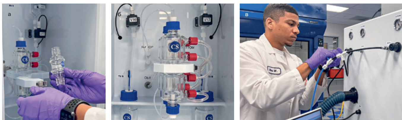
Рис.13. В CS136X могут использоваться реакционные сосуды от 20 до 200 мл (а); перемешивание реакционной смеси осуществляется поворотом реактора на 180° (б); для работы синтезаторов требуются отдельный источник электроэнергии, система подготовки воздуха и азота (в)
