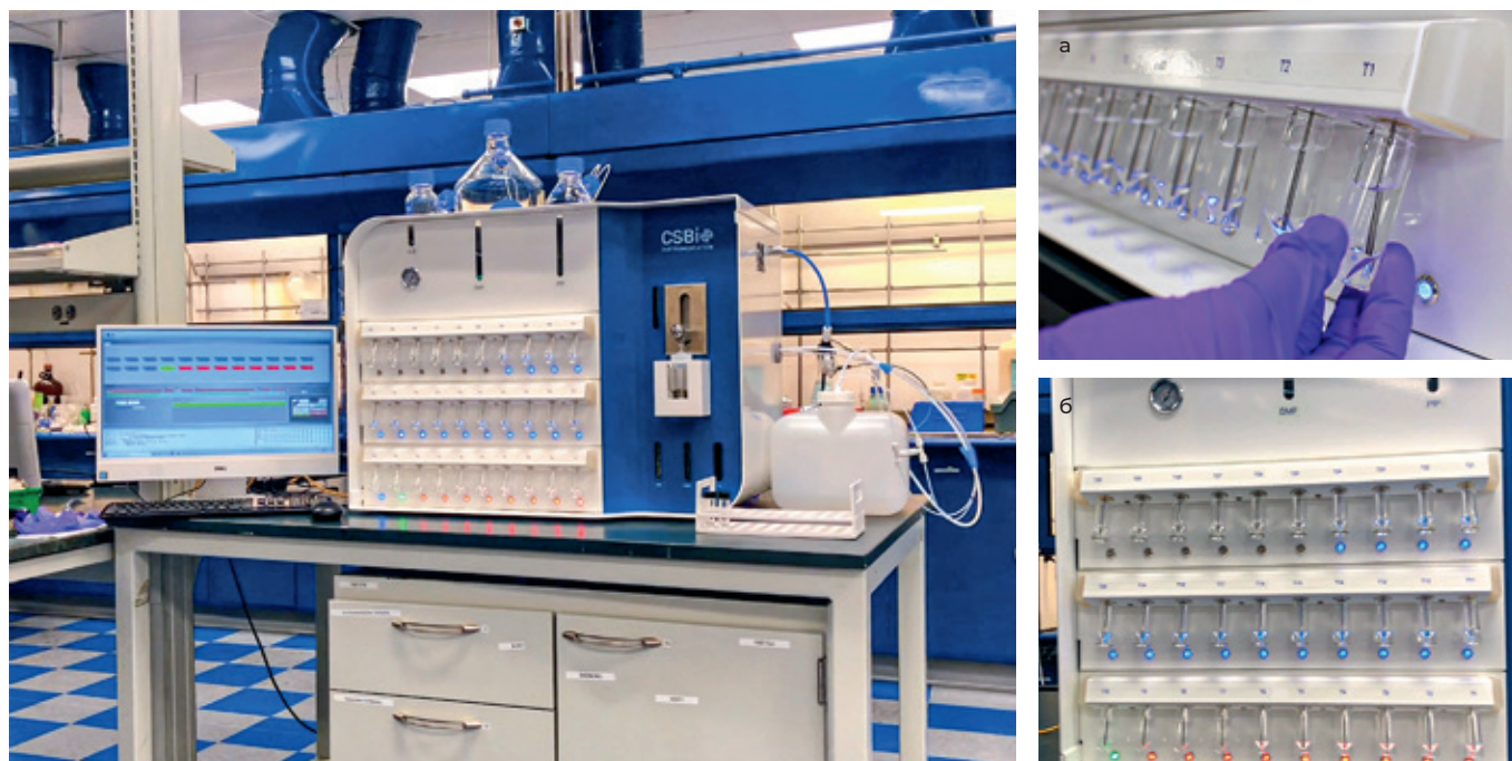
Рис.10. Автоматический синтезатор пептидов CSBio II прост в использовании: сосуды с аминокислотами легко установить и заменить (а); цветовая индикация позволяет легко контролировать процесс (б)
