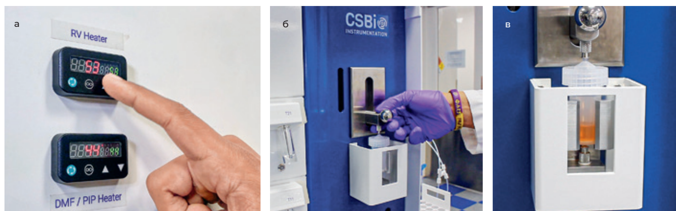
Рис.11. Кондуктивный нагрев обеспечивает постоянство и равномерность изменения температуры в течение всего синтеза (а); реакционный сосуд CSBio II оснащен запатентованной двухкамерной системой барботирования азота для более полного контакта растворителя со смолой (б, в)
