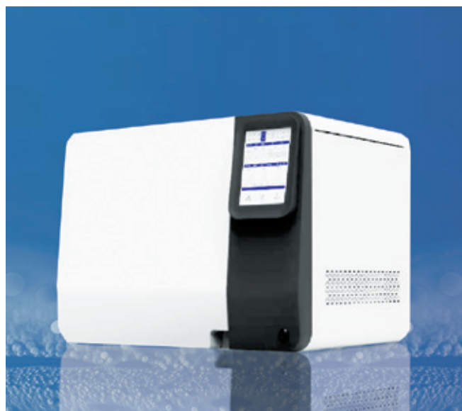
Рис. 2. Автоматизированный сетевой газовый хроматограф FCI-GC-2100
